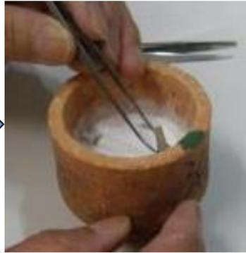
試料コーン及び標準コーンの試験用ルツボの中に設置
