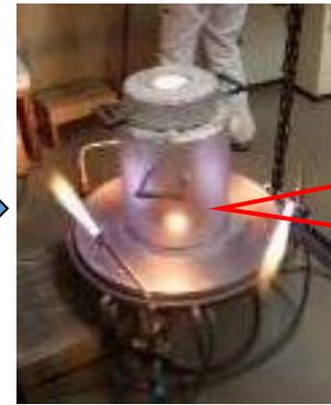
加熱はガス流量を調整しながら実施し、試料コーンが正しく曲がり、その先端が受台に接触するまで実施する
